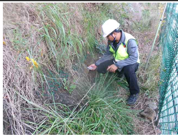
절리면 경사/경사방향 측정
